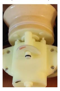
L'unité d'extraction est la combinaison d'une unité d'entraînement pneumatique (3) et d'un bassin de lit souple mobile (4), solidaires l'un de l'autre.
